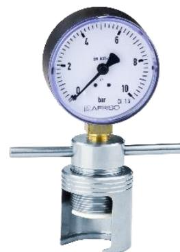
**FM-CO 80 zur Druckmessung in gerade eben/direkt zuvor gefüllten, noch nicht verschlossenen Flaschen mit Schraubverschlussmündung:**
